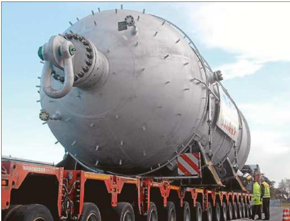
Ein Schwertransport im Kreisgebiet: Für die Kavernenanlage in Etzel wurde im Oktober ein Absorber angeliefert. Genehmigungsbehörde für den Transport ist das Straßenverkehrsamt. BILD: BÖKHAUS
